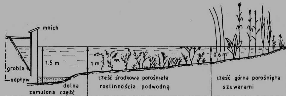
Ryc. 7. Schemat morfologicznego ukształtowania stawu rybnego wraz z budowlami technicznymi
