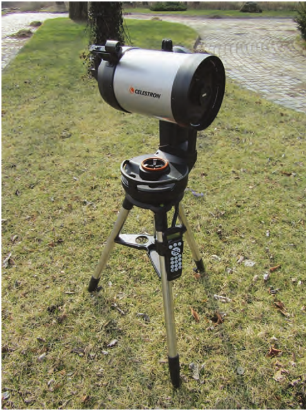
Teleskop planetarny z montażem go-to (śledzący obiekty na niebie) o średnicy 6 cali – fot. K. Ferenc
